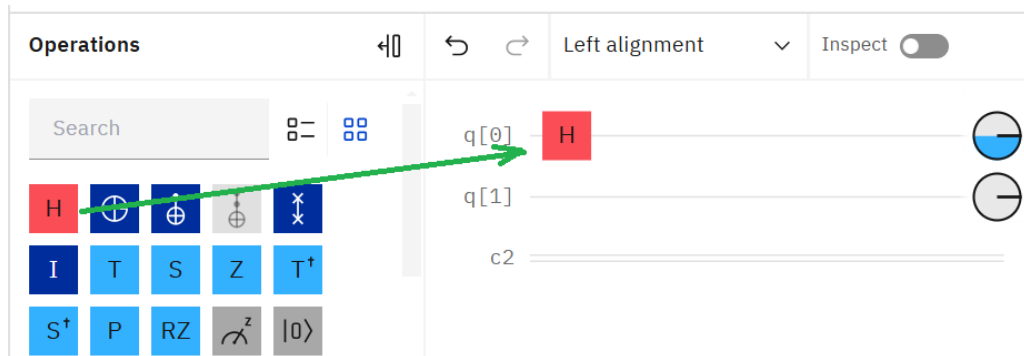
Рис. 2. – Додавання вентиля Адамара H до квантової схеми
